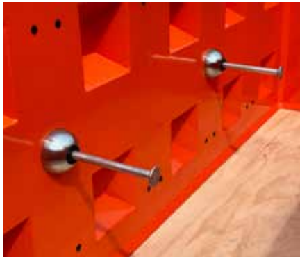
2 Legen sie den Gummi (BBGR002) um den Anker (BBHA025) in der Magneten.
