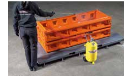
2 Die Anwendung von Öl in der Betonblock Forme
