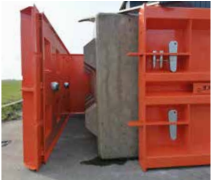
4 Wenn die Form geöffnet wird, bleibt der Magnet in der Form.
