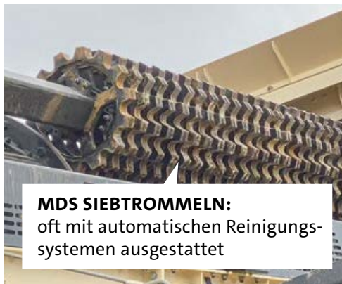
Kantenlängen von 800 mm und darüber sind für MDS Trommelsiebe kein Problem.
