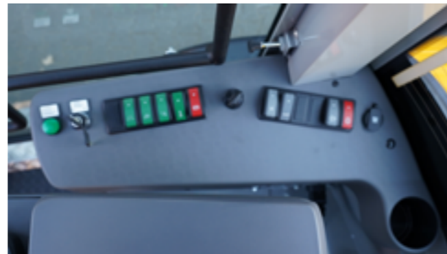
Übersichtliche Bedienkonsole: Anzahl der Schalter wurde reduziert.
