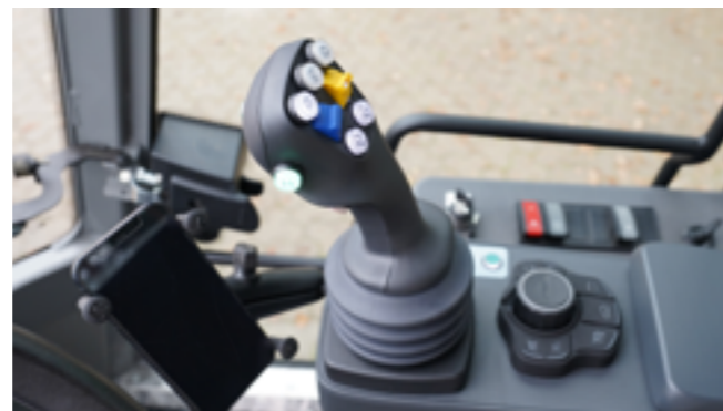
Ergonomische Bedienung mit Joystick und Paus Controller.
