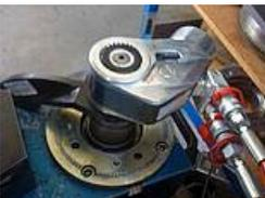
Ansonsten erfolgt die Prüfung zu fest kalkulierten Sätzen bei uns im Werk und das bis 30.000 Nm Drehmoment, 2.000 bar Druck, unter Berücksichtigung von Drehwinkel oder der spezifischen Schraubverbindung, was sonst niemand bieten kann. Die Grundlage und rückführbare Kalibrierungsmethode ist die DIN EN ISO 5393 und DIN EN ISO 6789, alle Messmittel von uns entsprechen den internationalen Standards, die passenden Adapter und Abstützungen der zahlreichen Modelle vorausgesetzt.
