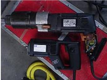
Eine gebrochene Griffschale an einem älteren Alkitronic-Schrauber muss nicht bedeuten, dass man einen neuen Alki kaufen muss. Unsere Gebrauchsmuster-geschützte SE-Schraubersteuerung im ergonomischen Spatengriff ersetzt das alte Teil.
