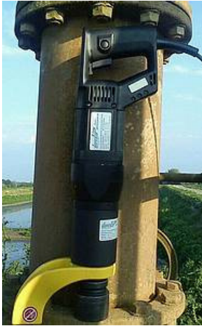
ETM2400 an Rohrleitung SW 41 - kurz (430mm) und kräftig (2.400Nm)
