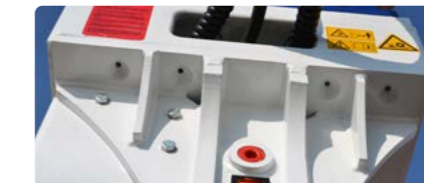
Wasserbedüsung zur Staubbekämpfung (optional)
