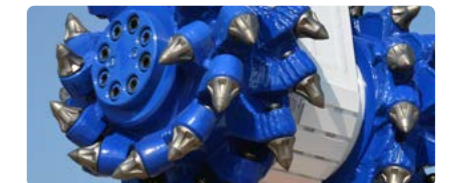
Optimierte Anordnung der Fräswerkzeuge
