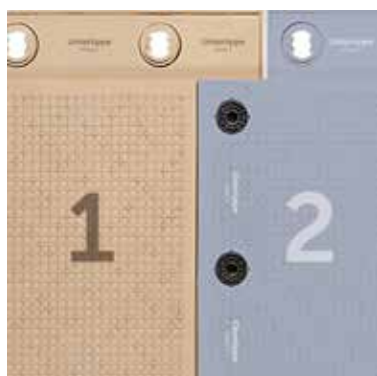
Lastübertrag durch Überlappung
