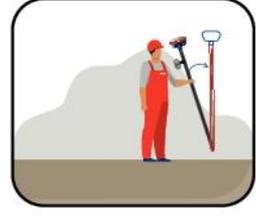
Der SpotMan verfügt über eine Neigungsfunktion, die Ihnen hilft, die korrekte vertikale Messung zu berechnen und Fehler zu vermeiden.
