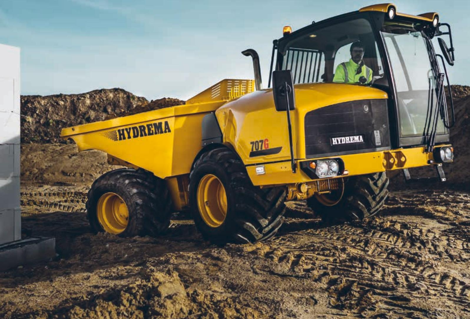
Ausgestattet mit allen Sicherheitsfunktionen eines großen Lkw. Mit nach vorne ausgerichteter Fahrerkabine, Knicklenkung und einem hydrostatischen Getriebe.
