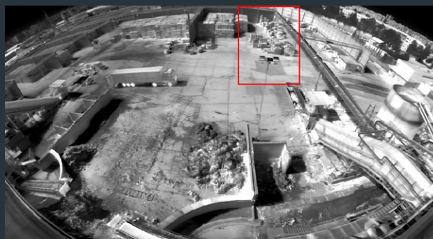
Infrarot-Panoramathermografie als Falschfarben-Darstellung. Das Gesamtbild wird aus vielen Einzel-Scans zusammengesetzt.
